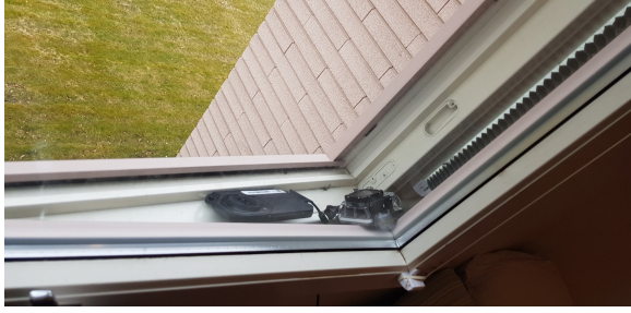
Figur 5.1.3: Utendørs testoppsett. IR-kameraet er lagt i en vinduskarm ved siden av et kamera. Det var så koblet til en bærbar datamaskin som kjørte en modifisert programvare som lagret de bildene hvor det var detektert blobs.
