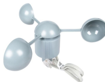
Figur 4.4.3: Figur av anemometeret som brukes.
