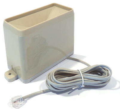
Figur 4.4.5: Figur av nedbørsmåleren som brukes.
