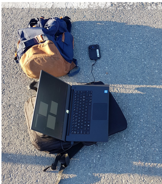
Figur 5.1.1: Utendørs testoppsett. Kamera var koblet til en bærbar datamaskin som kjørte programvaren.
