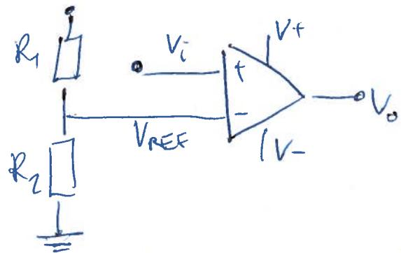
Når  $V_i$  er over  $V_{REF}$  vil outputen gå i retning til den høyeste spenningen den kan produsere,  $V_f$ . Motsatt når  $V_i$  går under  $V_{REF}$  vil outputen gå mot den laveste,  $V_-$ .  $V_{REF}$  er bestemt ~~av~~ av motstandene  $R_1$  og  $R_2$ .
